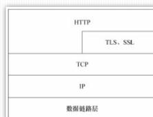
图 4-1 HTTP协议在OSI模型中的位置
