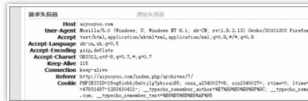
图 4-7 Firebug中的请求头信息
